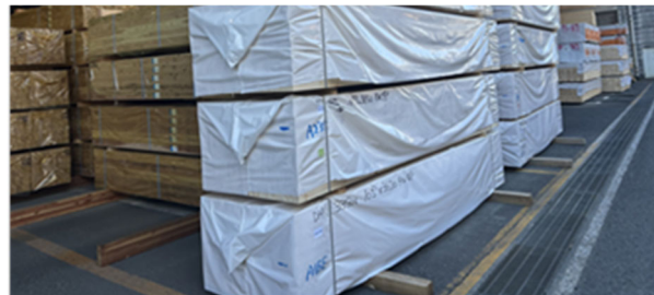
国内製材工場の木材梱包例（農業用ポリシートを使用）
